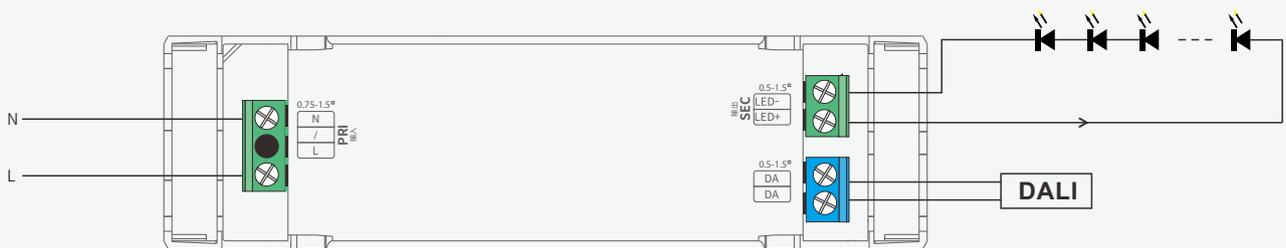
Wire diameter: 0.75-1.5<sup>ø</sup> [20-16AWG]
